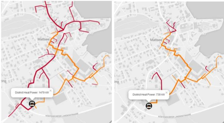
**Abb. 2:** Ausgehend vom Status Quo (orange) wird eine optimale Systemerweiterung (rot) für eine jeweilige Parametrisierung ausgewiesen.
